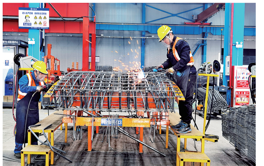
图为贾国华(右)焊接盾构管片钢筋骨架。
