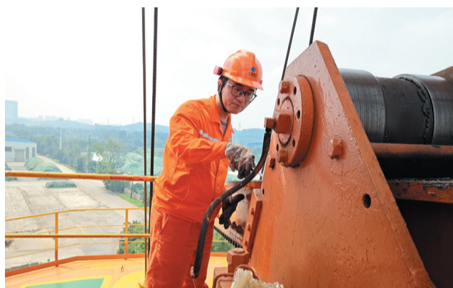
为保持机械“5S”干净整洁，大港分公司门机司机正在清理变幅机构齿条上的废油，并重新更换新润滑油，确保齿条正常运行。 大港分公司 盛泽宇 摄
