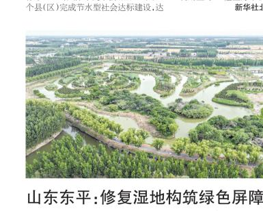
这是6月4日拍摄的东平县稻屯洼人工湿地水质净化工程,该工程是南水北调 东线治污工程的重要组成部分,日处理污水规模达5万吨(无人机照片)。 近年来,山东省东平县加大湿地修复和建设力度,筑牢东平湖生态保护屏障。
