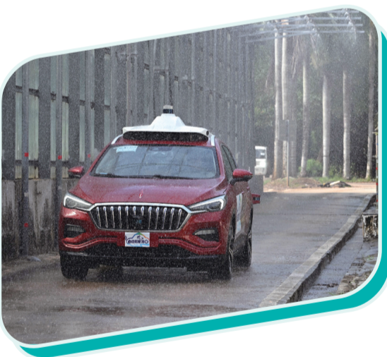
在海南省琼海市,坐落着我国建设最早的汽车试验场——海南汽车试验场。每年,都有数百辆汽车在这里进行上市前的“大考”。试验场占地面积1200亩,建有高速跑道、曝晒场、盐雾舱等设施,可进行汽车可靠性、耐久性、智能辅助驾驶等各类试验和测评。 新华社发
