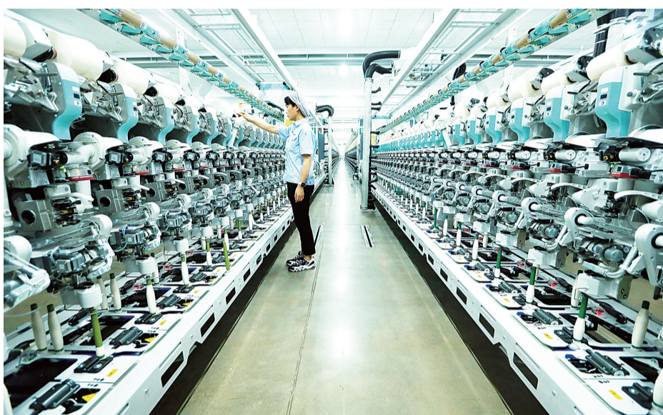
8月22日，青岛即发盛宝纺织有限公司工人在数字化纺纱智能生产线上生产高端纤维。该工厂全流程采用智能化纺纱成套装备，实现了运营智能化、装备智能化、制造数字化，可生产高端多功能纤维材料。新华社发
