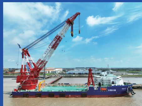
7月25日,中交海峰风电与振华重工联手打造的4000吨全回转起重船“海峰2001”在振华重工启东海工顺利交船。
