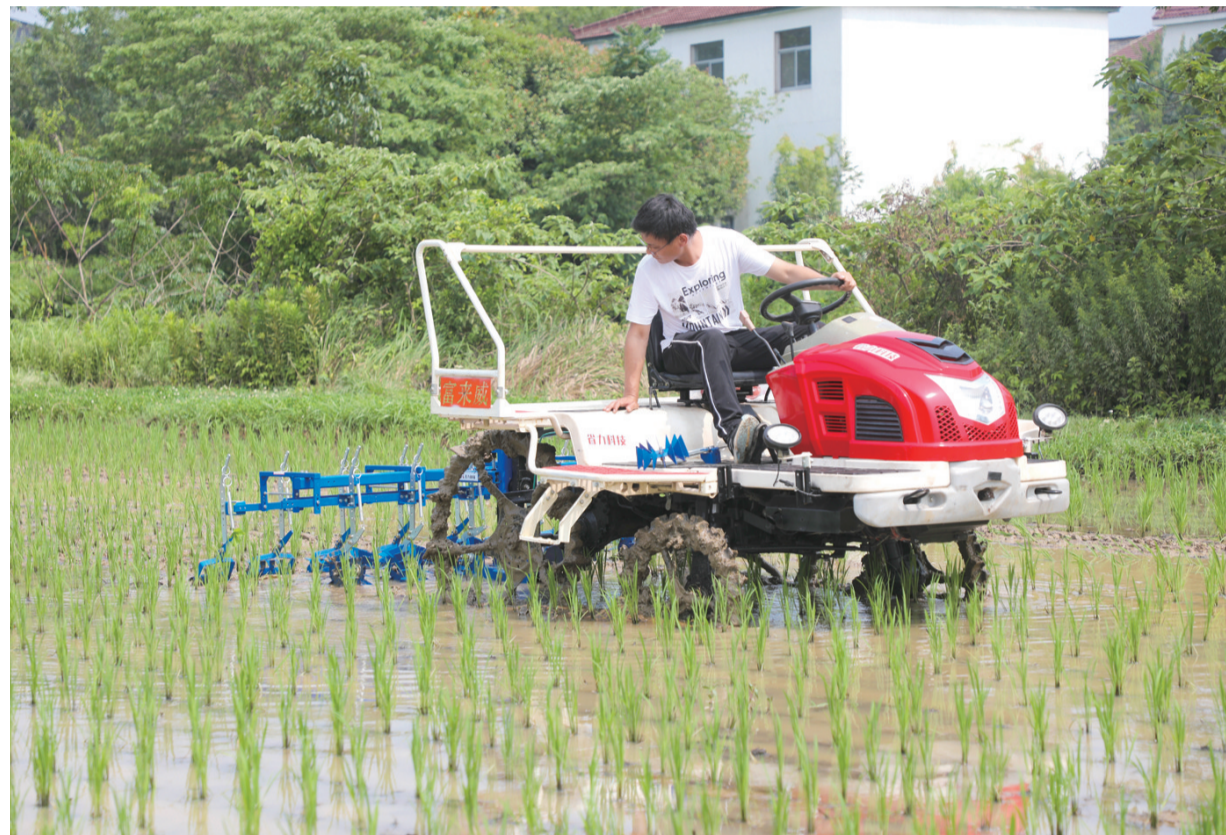
我市首次演示水田机械化除草 6月20日,结合水稻田间管理重要节点,市农业机械技术推广站在句容市戴庄村举办水田除草机械化技术现场演示会,现场展示了水田除草机新款机具,该机器通过物理除草的方式实现了行间、株间除草,除草率高,有效解决水稻田复杂作业环境下智能、高效、低损机械除草的问题。 黄帅 常国政 下丽娜 黄修德 摄影报道
