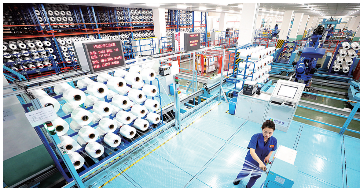
位于江苏省苏州市吴江区的恒力(苏州)产业园内的高性能涤纶工业丝智能车间内,员工对工业丝进行包装前的外检作业(3月15日摄)。
