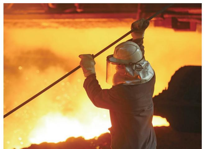
工人在鞍钢新4号高炉进行高炉出铁作业。
