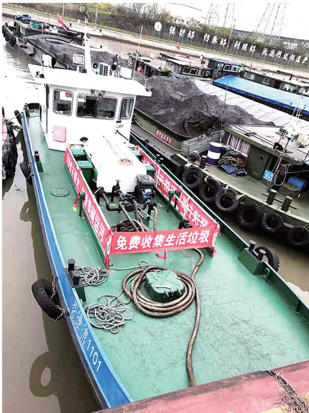
舱船因地制宜安装生活污水柜。”市交通运输综合行政执法支队相关负责人介绍，截至12月上旬，共计600艘小吨位船舶完成改造，实现全水域防污治理升级焕新。
