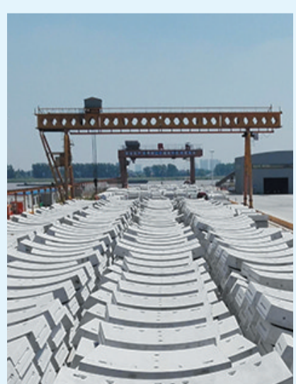
中交二航三公司镇江管片预制厂生产的盾构管片 方良龙 摄
