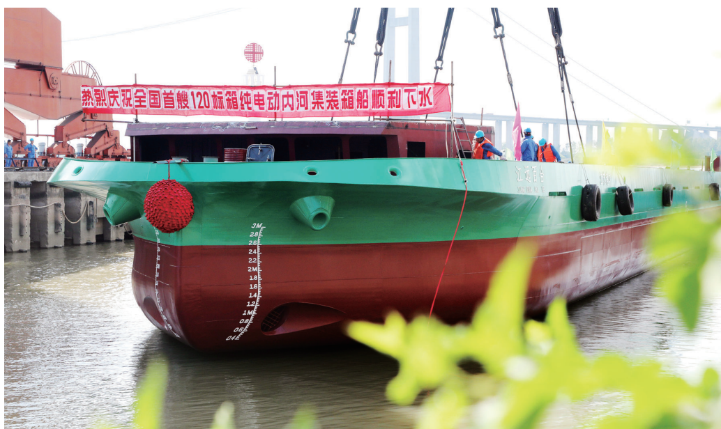
8月8日，由江苏省镇江船厂（集团）有限公司为江苏远洋运输有限公司建造的我国首艘120标箱纯电动内河集装箱船在镇江高新区顺利下水。该船根据京杭运河航道通航特点进行定向开发，设计采用纯电池推进方式，以高安全性的磷酸铁锂电池为能源载体，以集装箱式电池作为动力源，采用“即插即拔”式换电模式，可实现航行全程零排放。该船的开发与使用是我省加快绿色港航发展，助力“双碳”目标实现的又一创新举措。 文雯 朱大智 摄影报道
