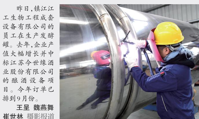
昨日，镇江江工生物工程成套设备有限公司的员工在生产发酵罐。去年，企业产值大幅增长并中标江苏今世缘酒业股份有限公司的酿酒设备项目。今年订单已排到9月份。
